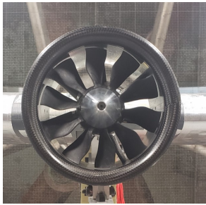
Fig. 2 Jetfan 130 Pro EDF unit.
