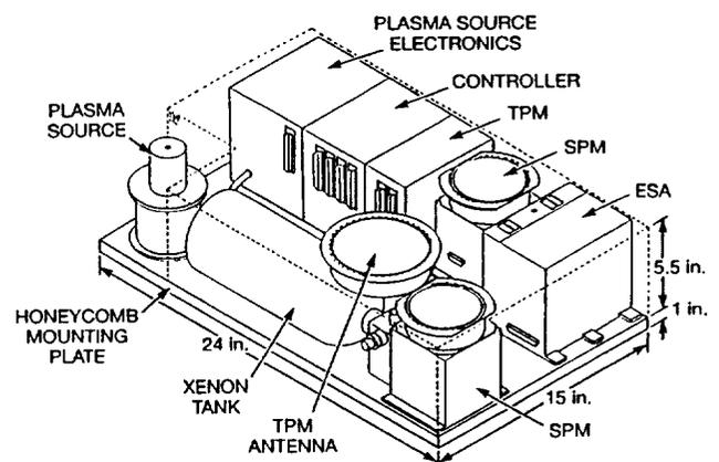
FIGURE 1. CHARGE CONTROL SYSTEM
